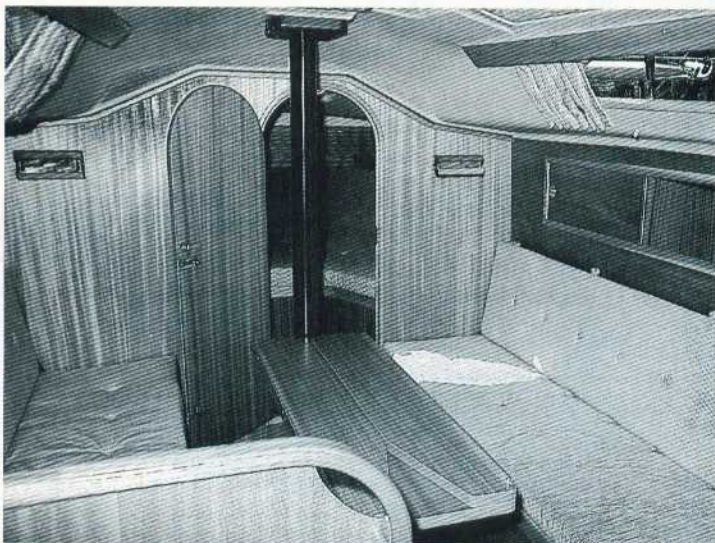
Der symmetrische Tisch läßt sich beidseitig nach oben umklappen, dadurch wird der Weg nach vorn frei gemacht.
